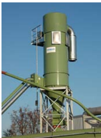
Круглый фильтр для деревообрабатывающей промышленности
