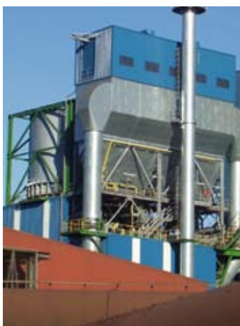
Фильтр, устойчивый к скачкам давления, для пылеудаления при размельчении угля
