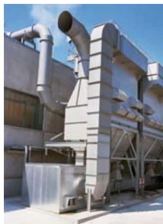
Рядный фильтр для производства древесных плит
