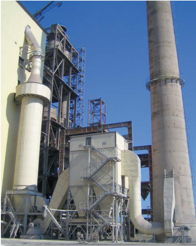
Figure 6: EMC filter plant at CESLA, Slanzy cement works, Russia Bild 6: EMC-Filteranlage bei CESLA, Zementwerk Slanzy, Russland
