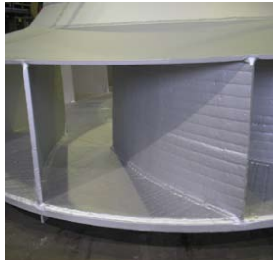
Laufrad geschützt durch Auftragsschweißung
