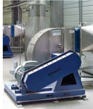
Edelstahlausführung der Medium führenden Teile
