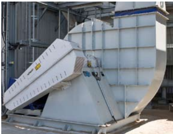
Förderventilator mit Riemenantrieb
