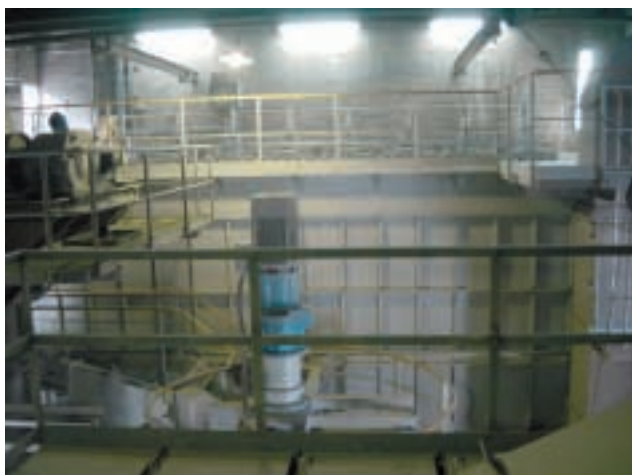
BILD 7: Blick auf die Entstaubung des Sichters. Im Vordergrund ist das Kopfteil des Sichters zu erkennen, im hinteren Teil des Bildes das Filter mit EMC
