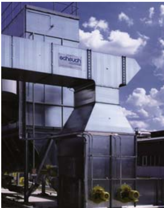
Ventilatoreinheit in der Holzindustrie Fan unit in the Wood Processing Industry
