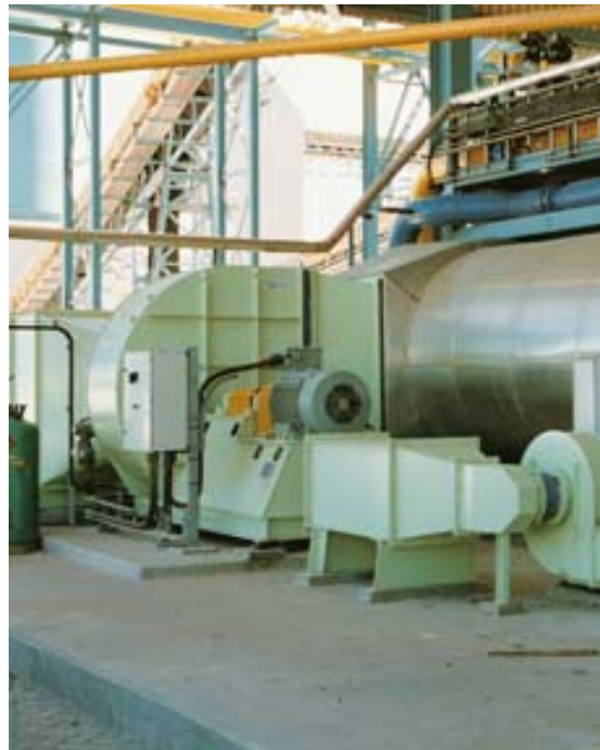
Ventilator für Kohletrockner in der Stahlindustrie Fan for coal dryer in the Steel Industry
